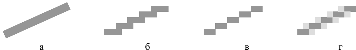
Рис. 1. а) Линия в векторном формате; б)—г) линия а) в растре, или разные способы дискретизации линии а)
