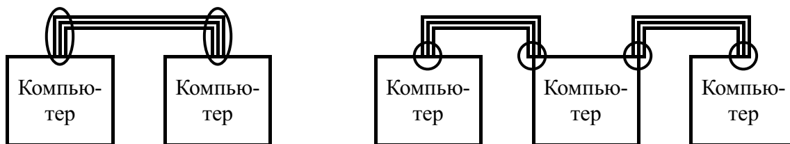
Рис. 3. Соединение двух а) и трех б) компьютеров без хаба. Кругами обведены разъемы
