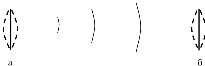
Рис. 5. Излучение звука динамиком а) и прием его микрофоном б)
