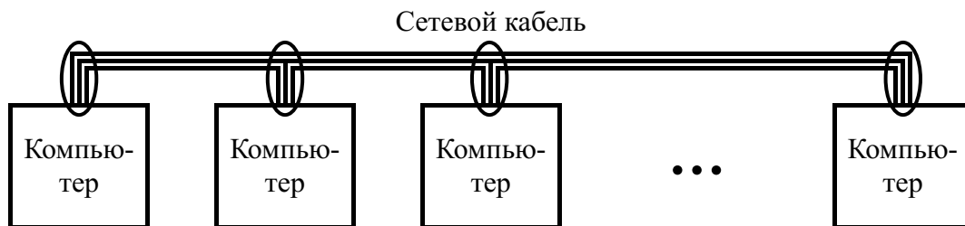
Рис. 1. Линейная архитектура сети. Кругами обведены разъемы
